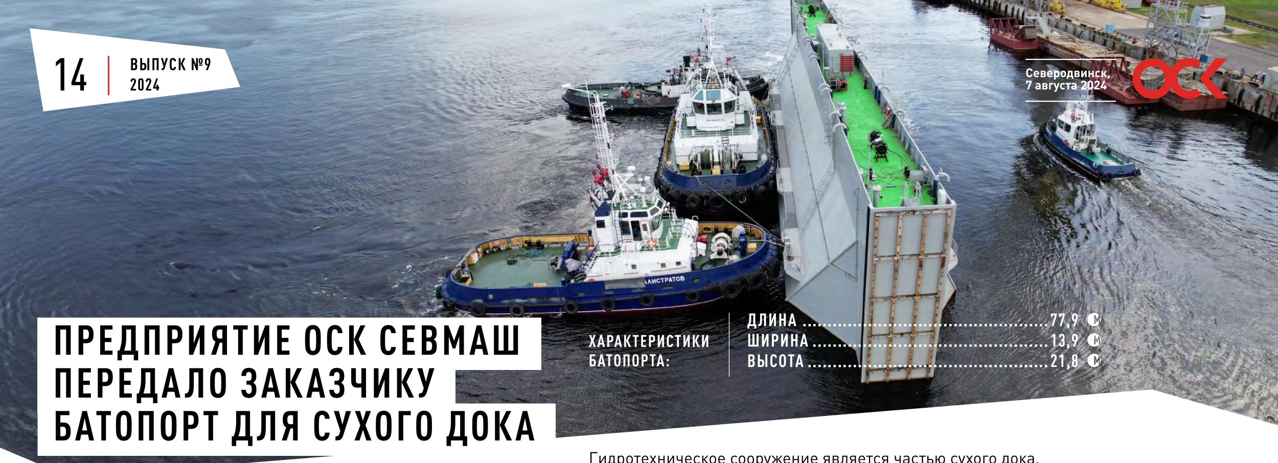
СЕВМАШ ПОСТРОИЛ И ПЕРЕДАЛ 35 СУДОРЕМОНТНОМУ ЗАВОДУ (ФИЛИАЛУ ЦС «ЗВЕЗДОЧКА») БАТОПОРТ ПРОЕКТА 1418 Гидротехническое сооружение является частью сухого дока, предназначенного для ремонта кораблей и судов.
